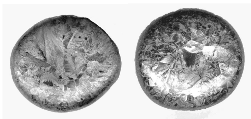
Рис. 2. Внешний вид слитков гафния
