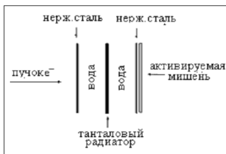
Рис. 2. Схема стенда для облучения образцов
