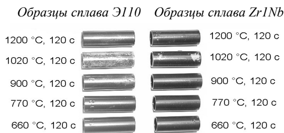
Рис. 4. Вид образцов труб их сплавов Zr1Nb и Э110 после выдержки в среде водяного пара при указанных температурах в течение 120 с
