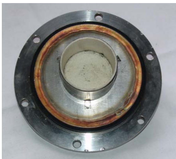
Рис. 3. Фланец с закрепленным тиглем для размещения нагревателя
