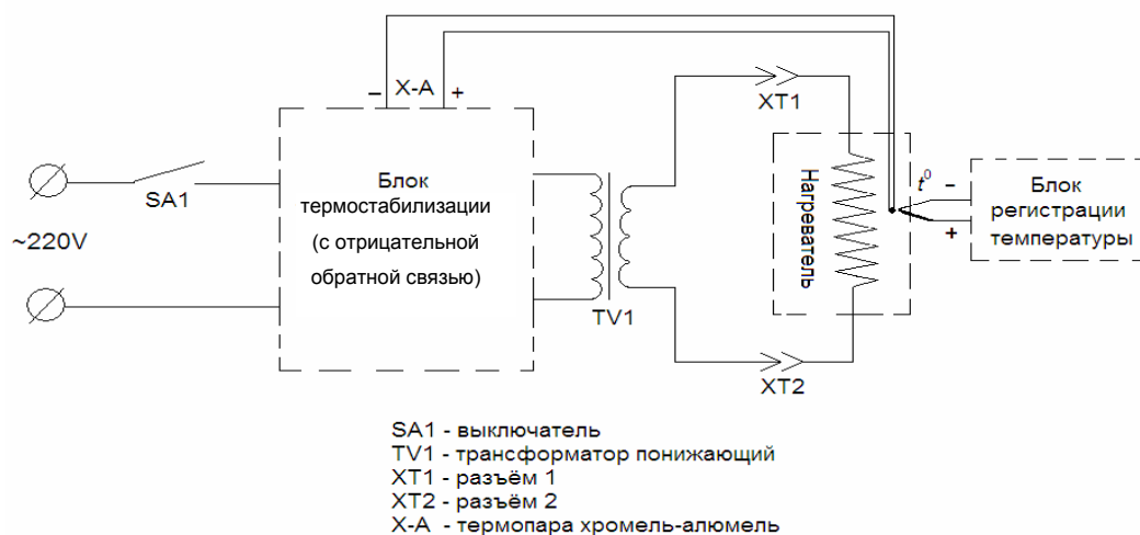
Рис. 1. Электрическая схема печи для подогрева графитовых образцов
