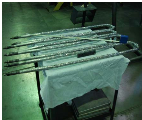
Рис. 1. Прутки йодидного гафния, полученного в аппарате Г-20 из оборотов плавильного и деформационного переделов
