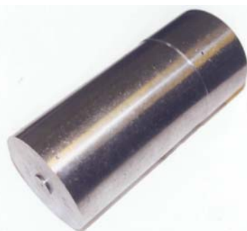
Рис. 2. Слиток кальциетермического гафния, выплавленный в печи ЕМО-250
