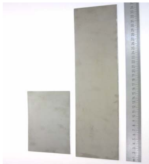
Рис. 7. Пластины, изготовленные из слитка гафния, выплавленного из двойной шихты
