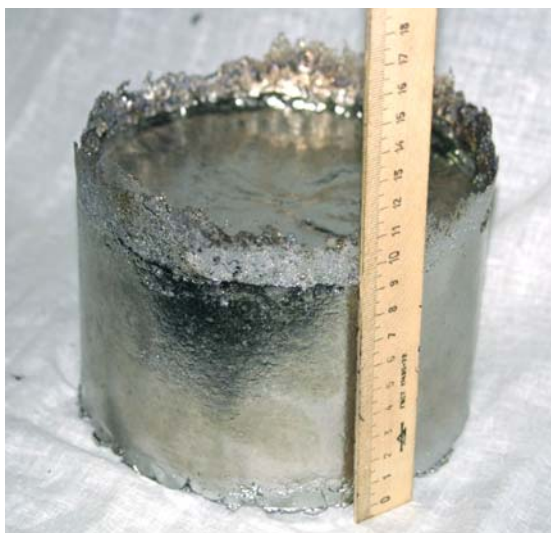
Рис. 6. Опытный слиток массой 22 кг и диаметром 158 мм, выплавленный из двойной шихты (КТГ + ИГ)
