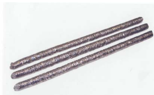
Рис. 3. Прутки йодидного гафния марки ГФИ-1, полученные в аппарате Г-3
