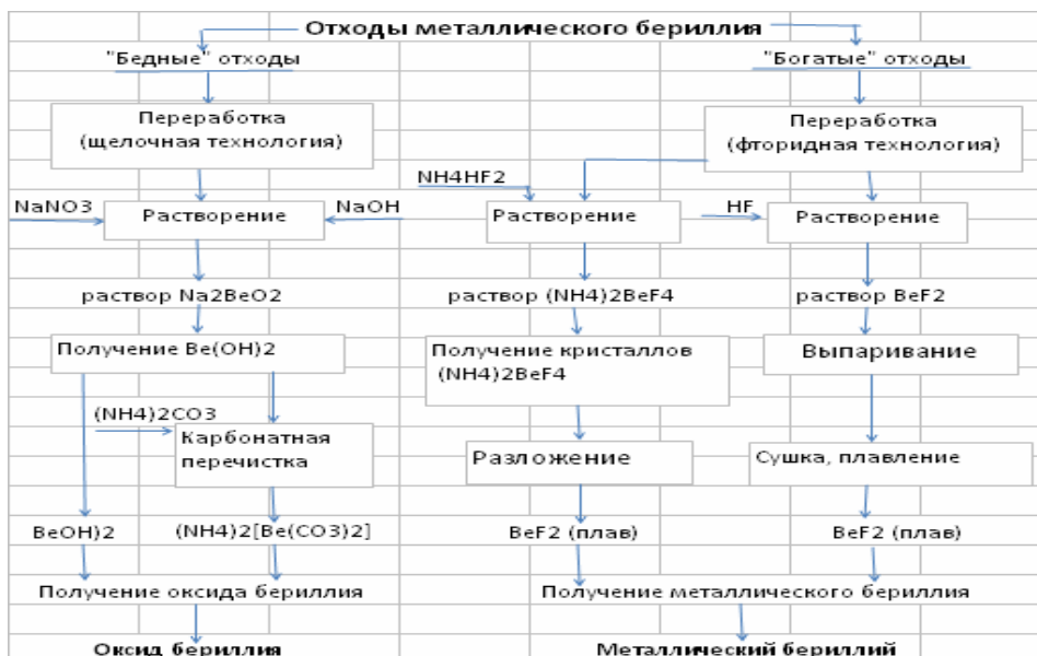
Рис. 1. Концепция переработки отходов бериллия с получением оксида бериллия и металлического бериллия высокой чистоты
