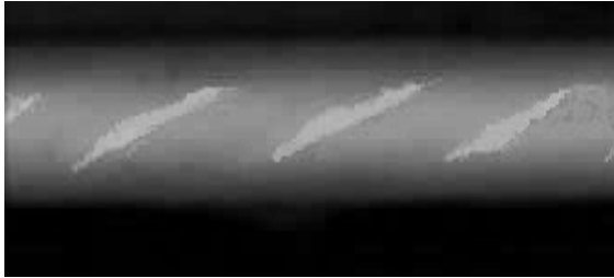
Рис. 3. Типичный вид страт, полученный с помощью скоростной видео-фотокамеры Casio Exilim Pro FX-1
