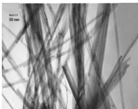
Рис. 2. Мікрофотографія зразка при добавлянні менше 45 мас.% F на одиницю маси Ti. (Суміш політитанатів: \text{Na}_2\text{Ti}_3\text{O}_7 і \text{K}_2\text{Ti}_4\text{O}_9 .)
