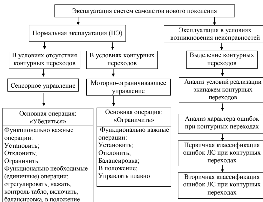
Рис. 7. Информационные виды управления СНП при контурных переходах
