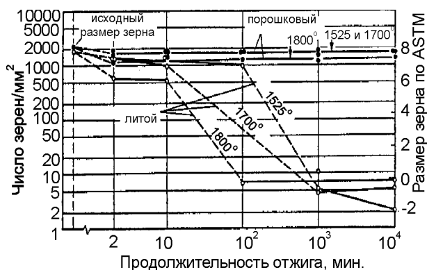
Рис. 2. Изотермический рост зерна молибдена [11].
