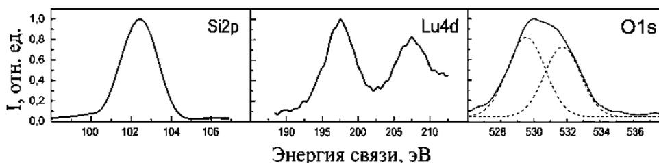
Рис. 4. Нормированные рентгеновские фотоэлектронные спектры Si2p-, Lu4d- и O1s-основных оболочек с поверхности образца гетерочастиц SiO<sub>2</sub>/Lu<sub>2</sub>O<sub>3</sub>-1.
