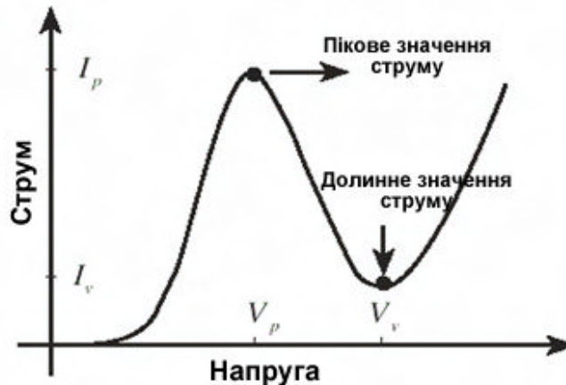
Рис. 2. Типова вольт-амперна характеристика РТД-пристрою. Максимальний струм ( I_p ) спостерігається при максимальній напрузі ( V_p ), а мінімальний струм ( I_v ) спостерігається при мінімальній напрузі ( V_v )
