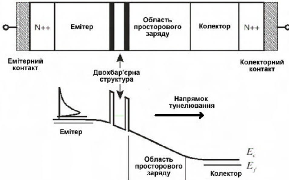
Рис. 1. Поперечний переріз РТД-пристрою та відповідні енергетичні зони під напругою прямого зміщення
