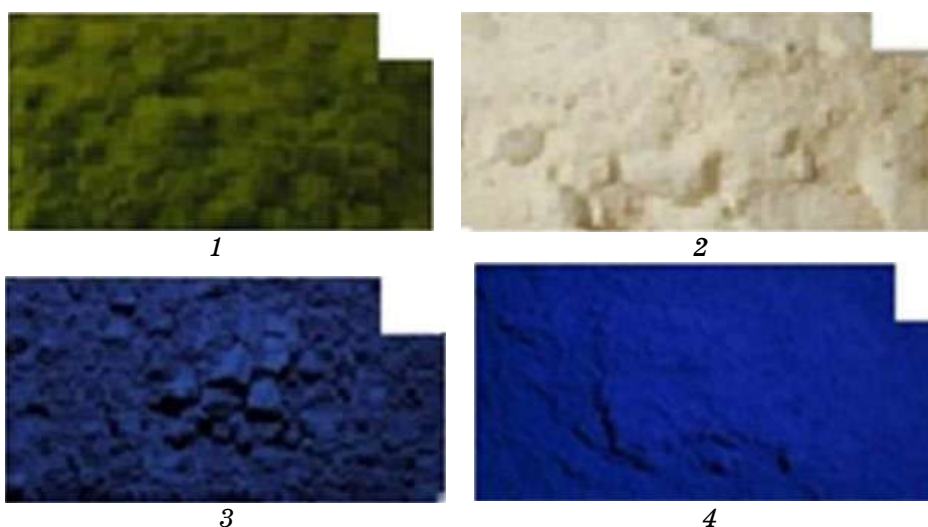
Рис. 7. Колірний тон пігментів після прожарювання: 1 — оксид кобальту; 2 — оксид алюмінію; 3 — складні оксиди кобальту та алюмінію (1/3 алюмінію і 2/3 кобальту); 4 — складні оксиди кобальту та алюмінію (2/3 алюмінію і 1/3 кобальту).
