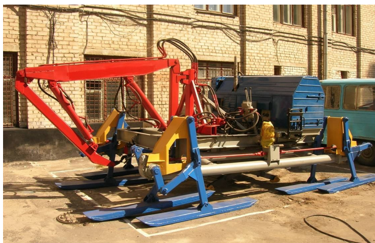
Рисунок 2 – Шагающая машина «Восьминог»
