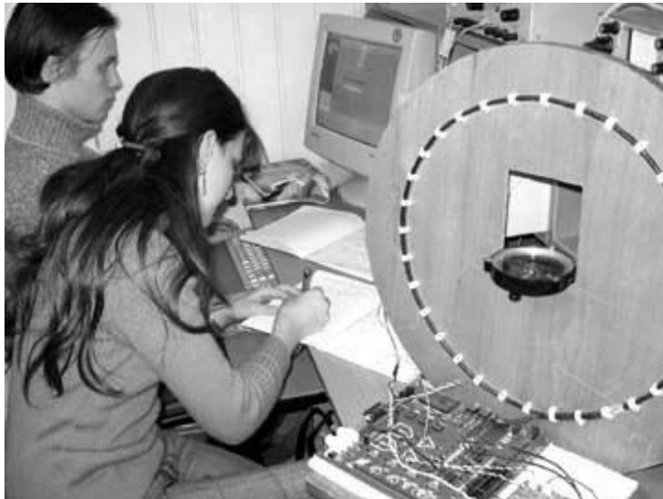
Рис. 6. У новій лабораторії електрики та магнетизму. Студенти вимірюють напруженість магнітного поля Землі за допомогою мікроконтролера та персонального комп'ютера.
