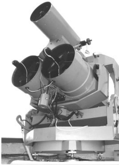
Рис. 19. Лазерний віддалемір 2-го покоління (1980-ті роки).
