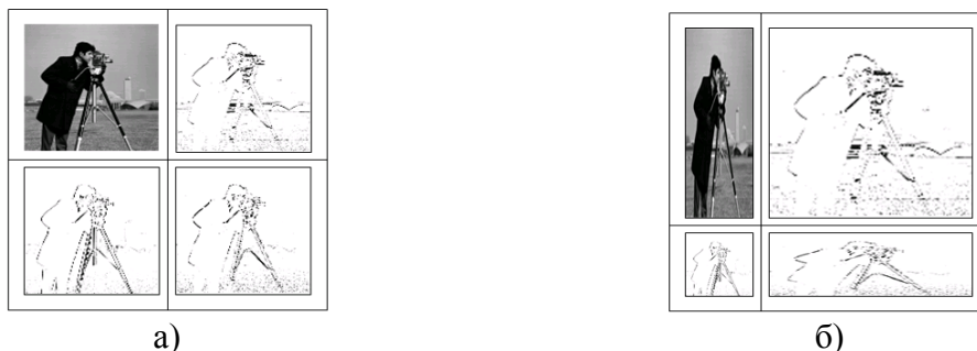
Рисунок 3 – Элементы L, H_1, H_2, H_3 , сформированные с использованием коэффициентов сжатия: а) – k_h = 0,5, k_v = 0,5 ; б) – k_h = 0,75, k_v = 0,25
