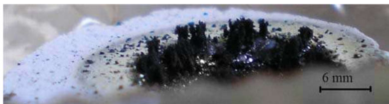
Рис. 3. Структуры, сформированные на поверхности образца из уплотненного порошка композита h -BN–ламповая сажа.
