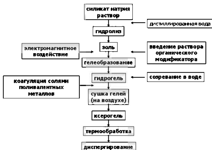
Рис. 1. Схема золь–гель-процесса получения органосиликатного нанокompозита.
