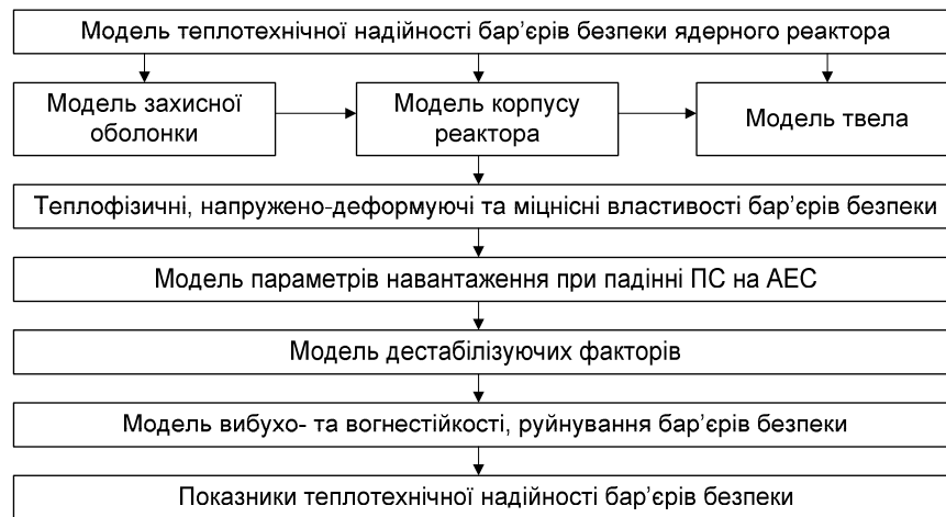
Рис. 1. Структура моделювання надійності бар'єрів безпеки АЕС.
