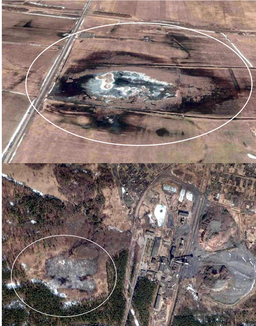
Рис. 2. Локальне просідання земної поверхні в зоні виробничої діяльності шахт (сmt Соснівка). Джерело інформації: Google Планета Земля: бесплатная версия — www.earth.google.com
