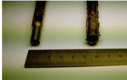
Рис. 2. Нанокристалічний стрижень Zr_{50}Cu_{30}Al_{10}Ni_{10} ( d = 10 мм).
