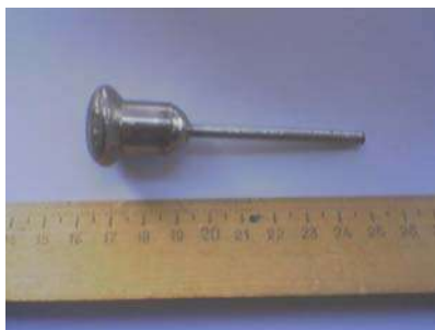
Рис. 1. Аморфний стрижень Zr_{50}Cu_{30}Al_{10}Ni_{10} ( d = 4 мм).
