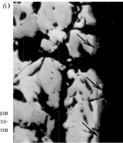
Рис. 3. Микроструктура образцов терморезистора до (а) и после воздействия 1000 циклов импульсов тока (б)
