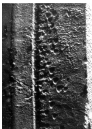
Рис. 1. Микрофотография поперечного скола парофазной эпитаксиальной гетеросистемы CdTe–КРТ, протравленной в селективном травителе
