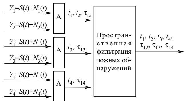
Рис. 4. Структура ПО сигналов в системе ПЗЛ, основанная на комбинации процедур предфильтрации, кросс-коррелятора и пространственной фильтрации ложных обнаружений (блок А раскрыт на рис. 3)
