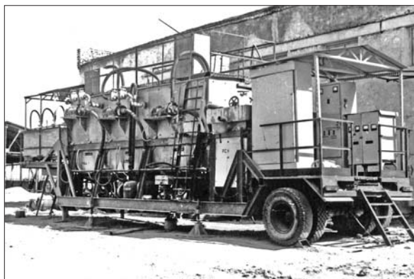
Рис. 3. Установка для разложения цианидов в пульпе
