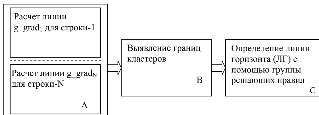
Рисунок 4 – Схема алгоритма обработки входных видеоданных для распознавания линии горизонта у БПЛА
