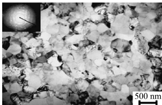
Рис. 2. Микроструктура сплава Ti_{49.8}Ni_{50.2} после проведения 8 проходов РКУП при 450^\circ C [30]
