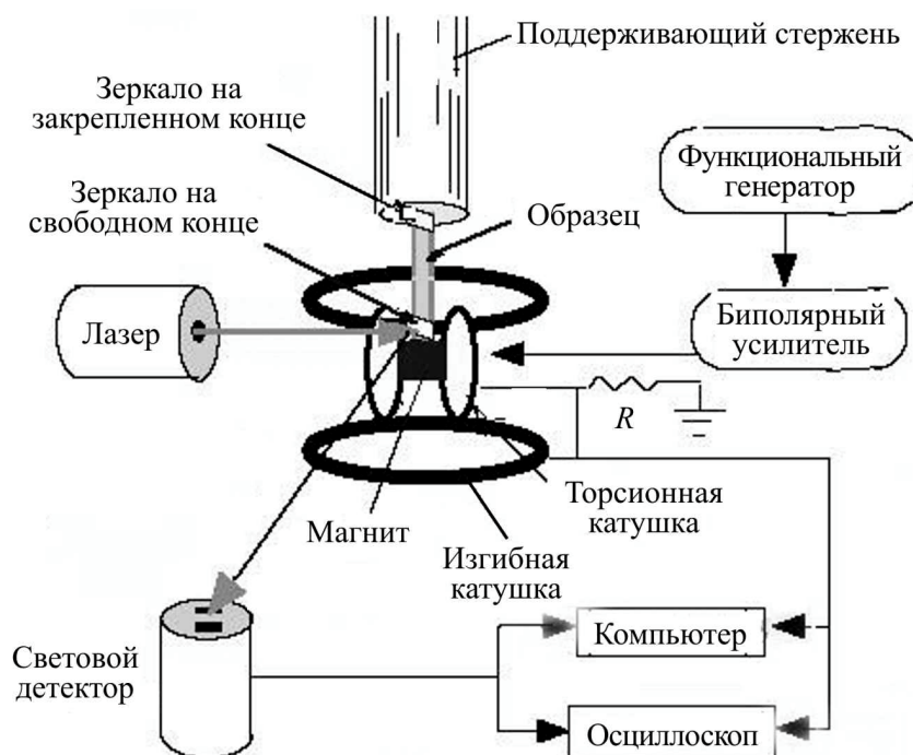
Рис. 2. Схема автоматической установки ВТ на основе прямого маятника
