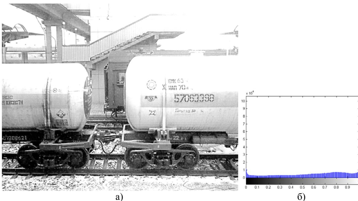
Рисунок 4 – а) изображение, полученное после применения преобразований 2-го этапа предложенного метода; б) его гистограмма
