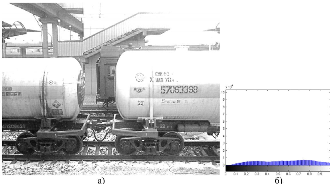
Рисунок 3 – а) полутоновое изображение, полученное после применения преобразований 1-го этапа предложенного метода; б) его гистограмма
