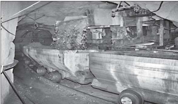
Рис. 1. Завантаження уранової руди у вагонетки вібраційним випуском
