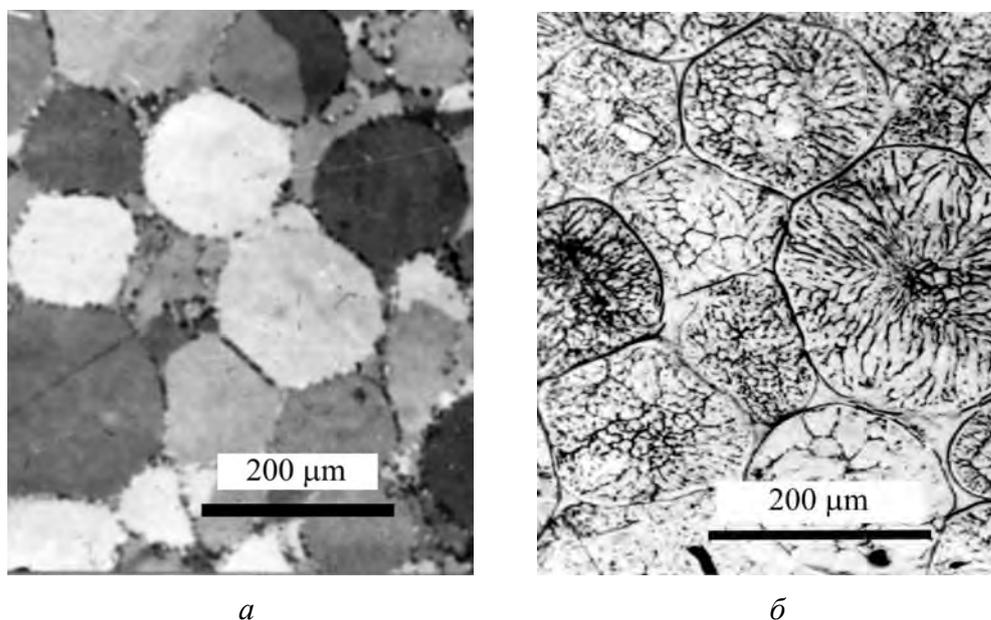
**Рис. 3.** Микроструктура компактной бериллиевой заготовки дистиллированного металла, спрессованного методом ГИП: *а* – зеренная структура компактного бериллия; *б* – дендритная структура зерен в виде блоков, сохраняющаяся в компактном материале после высокотемпературного прессования
