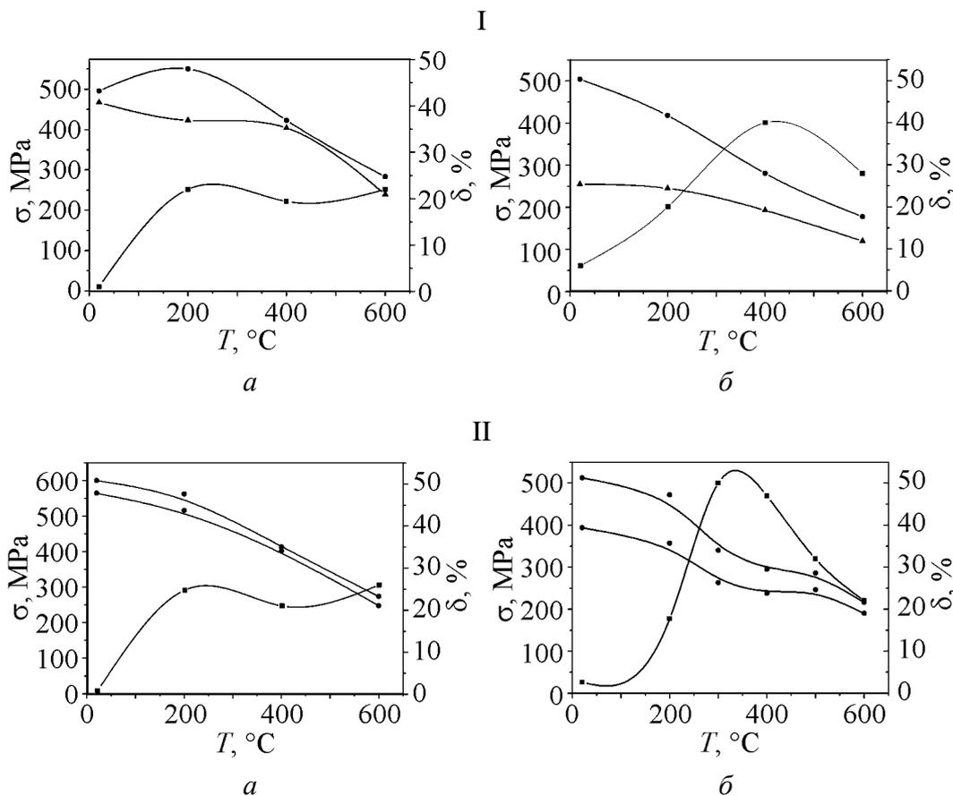
**Рис. 2.** Температурная зависимость механических свойств бериллия, экструдированного вдоль направления приложенной нагрузки (I) и под углом  $90^\circ$  к этому направлению (II): *a* – исходное состояние после деформации; *б* – после отжига при  $T = 750^\circ\text{C}$  в течение 2 h;  $\bullet$  –  $\sigma_b$ ,  $\blacktriangle$  –  $\sigma_{0,2}$ ,  $\blacksquare$  –  $\delta$
