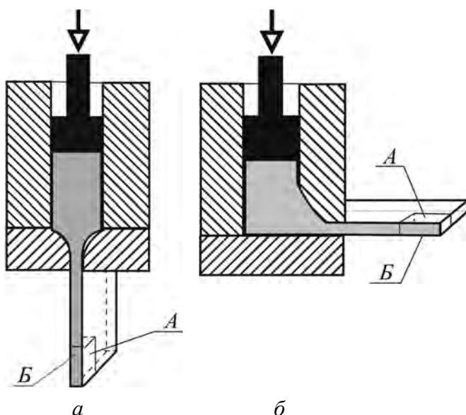
**Рис. 1.** Принципиальные схемы пластической деформации бериллия, экструдированного в полосу  $16 \times 3.2$  мм: *a* – вдоль направления приложенной нагрузки; *б* – под углом  $90^\circ$  к направлению приложенной нагрузки
