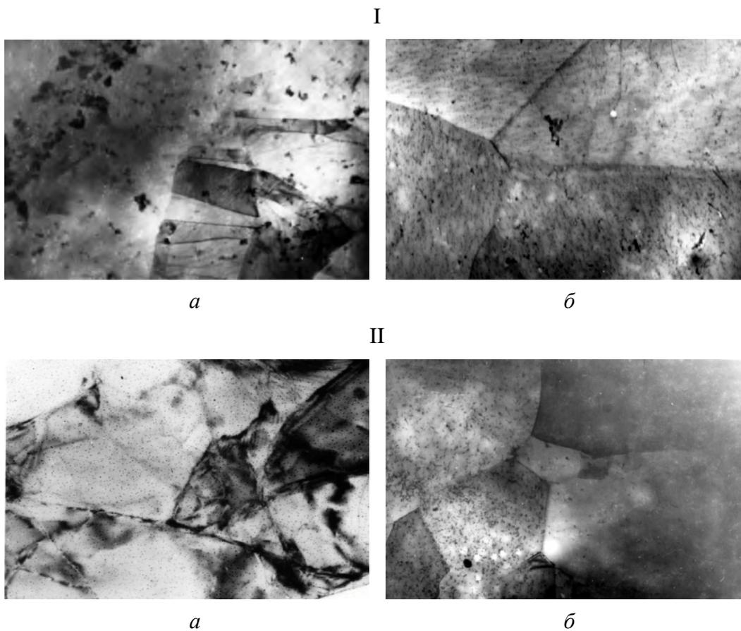
**Рис. 5.** Субструктура бериллия, экструдированного в полосу вдоль направления приложенной нагрузки (I) и под углом  $90^\circ$  к этому направлению (II): *a* – в исходном состоянии после ИПД; *б* – после отжига  $750^\circ\text{C}$ , 2 h;  $\times 5000$
