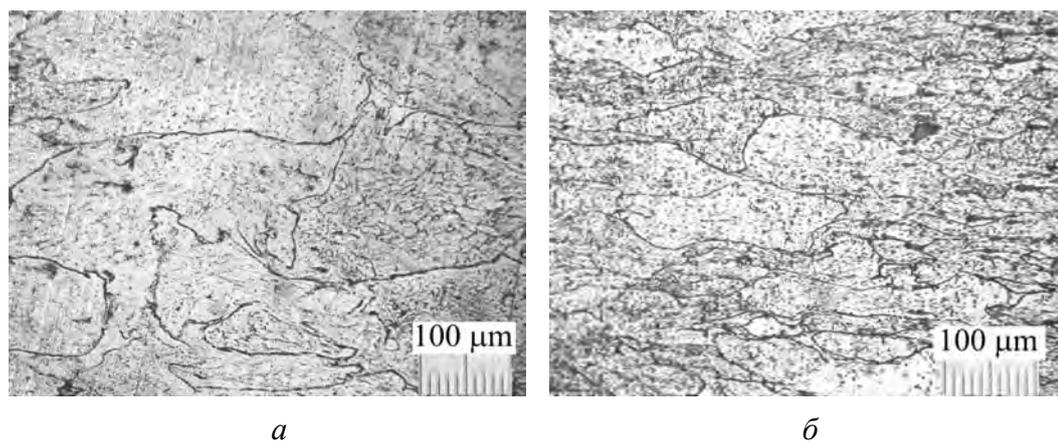
**Рис. 4.** Микроструктура деформированных образцов бериллия: *a* – экструзия вдоль направления приложенной нагрузки; *б* – экструзия под углом  $90^\circ$  к направлению приложенной нагрузки (ИПД)
