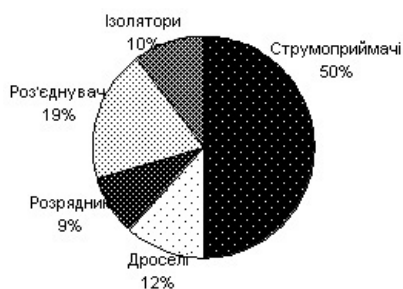
Рис. 1. Розподіл непланових ремонтів дахового обладнання.
