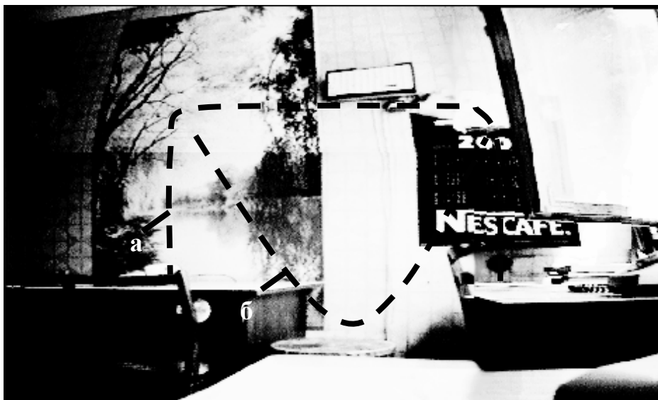
РИС. 5. Монтаж видеопоследовательности с заданной траекторией камеры: а – траектория движения камеры при съемке исходной видео- последовательности; б – заданная произвольная траектория
