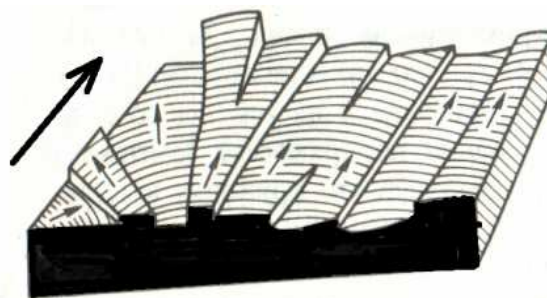
Рис. 4. Схема типичной поверхности усталостных изломов титановых сплавов, предложенная в работе [5].
