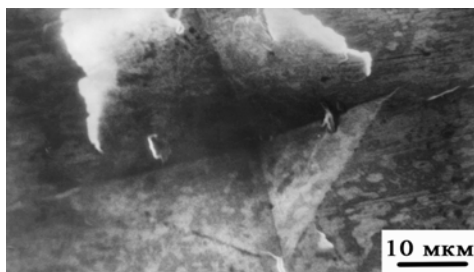
Рис. 6. Экструзия из отпечатка микротвердости в КК Al 63 Cu 25 Fe 12 [21].
