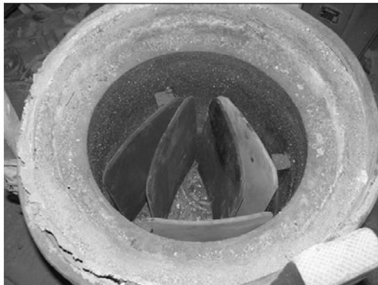
Рис. 11. Расположение керамических панелей внутри графитового тигля в индукционной печи перед реакционным спеканием.
