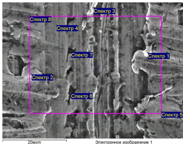
Рис. 3. Загальний вигляд поверхні матового гальванічного робочого шару
