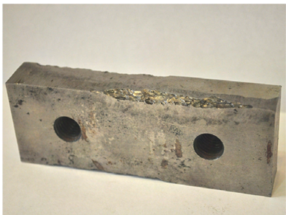
Рис. 1. Вид изношенного ножа для резки арматуры
