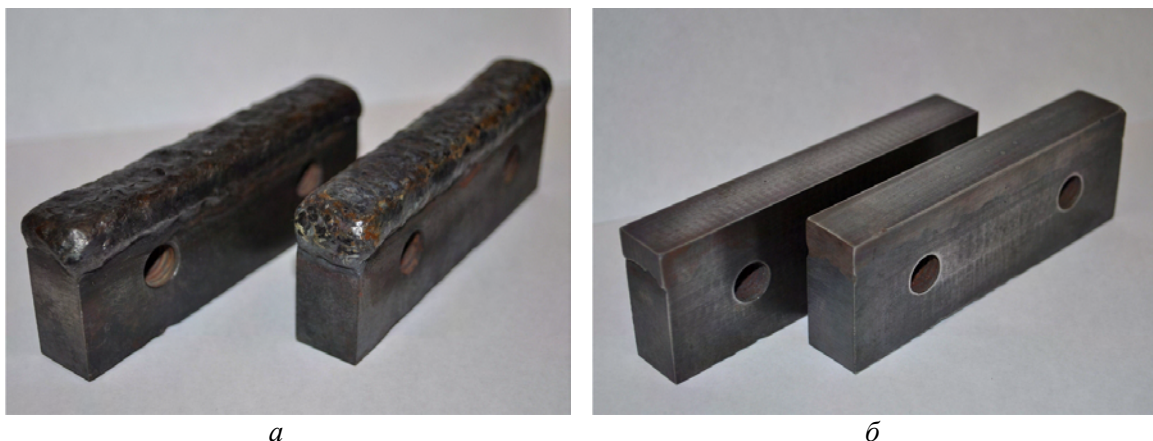
Рис. 3. Общий вид ножей для резания арматуры: а – после наплавки; б – после механической обработки
