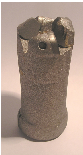
Рис. 4. Общий вид изношенного резца РШ-140Э
