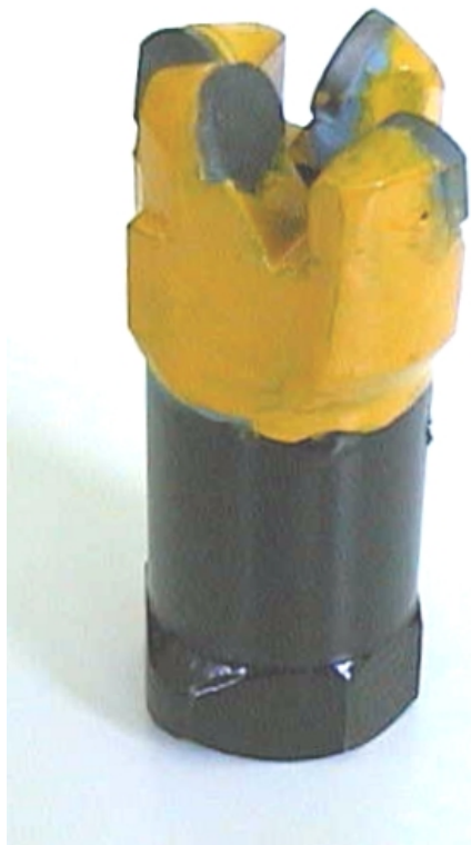
Рис. 3. Общий вид резца РШ-140Э
