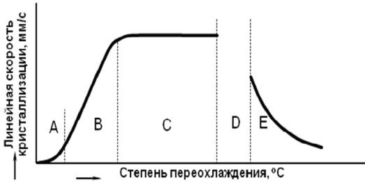
Рис. 5. Кривая влияния степени переохлаждения на линейную скорость кристаллизации [2].
