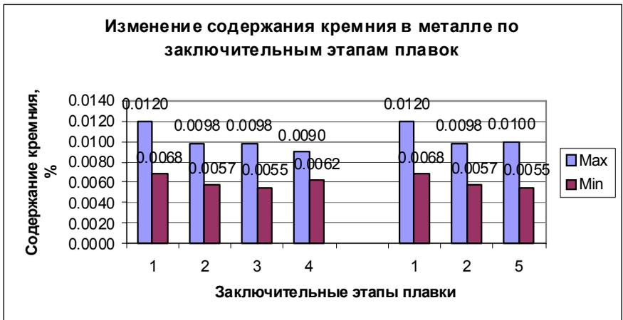
Рис.3. Изменение содержания кремния в металле по заключительным этапам плавок. Содержание кремния в чугуне – 0,48-0,83%.
