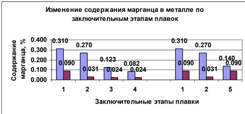
Рис.8. Изменение содержания марганца в металле по заключительным этапам плавки.
