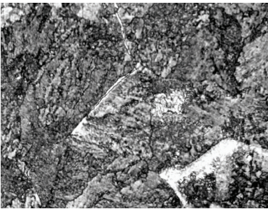
Рис.2. Микроструктура (а, в — \times 800 ) высокоуглеродистой стали, легированной хромом (а,б), и без легирования (в,г) после аустенитизации и последующего непрерывного охлаждения со скоростью 15...17^{\circ}\text{C}/\text{с} .
