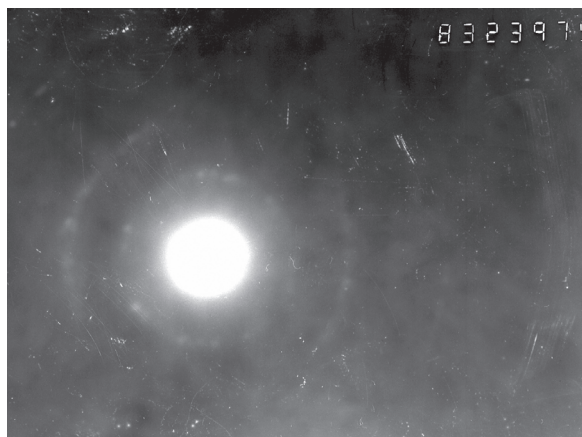
Рис. 8. Нанотрубка из нитрида титана ( a ) и ее электронограмма ( б )
