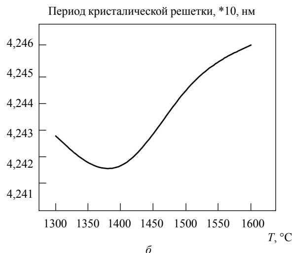
Рис. 4. Температурная зависимость отношения интенсивностей дифракционных пиков ((200)/(111)) (а) и периодов кристаллической решетки (б) нитрида титана в керамике, полученной с использованием вакуумной предобработки
