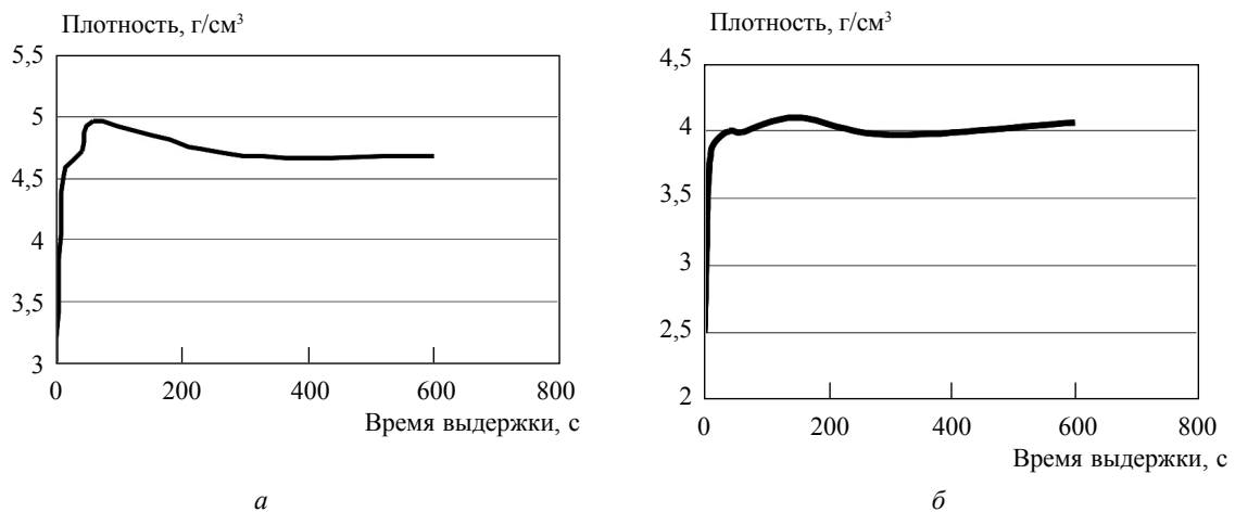
Рис. 3. Зависимость плотности порошкового тела на основе нитрида титана от времени барической обработки при постоянном давлении 3 ГПа: а – порошок с размером частиц 40–60 мкм; б – нанопорошок
