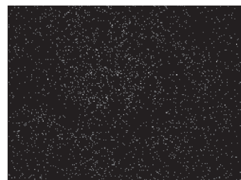
Рис. 4. Электронно-микроскопический снимок полиминеральной монтмориллонито-гидрослюдисто-каолинитовой глины, науглероженной при 660 °С, и распределение химических элементов в структуре образца
