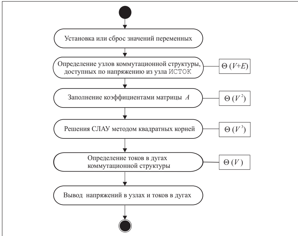
Рис. 7. Диаграмма состояний расчета напряжений и токов в коммутационной структуре
