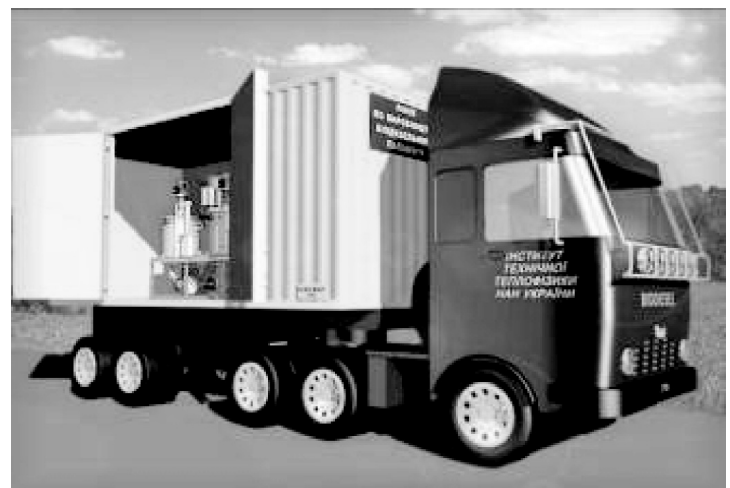
Рис.5. Мобильная установка по производству рапсо-этилового эфира (проект).
