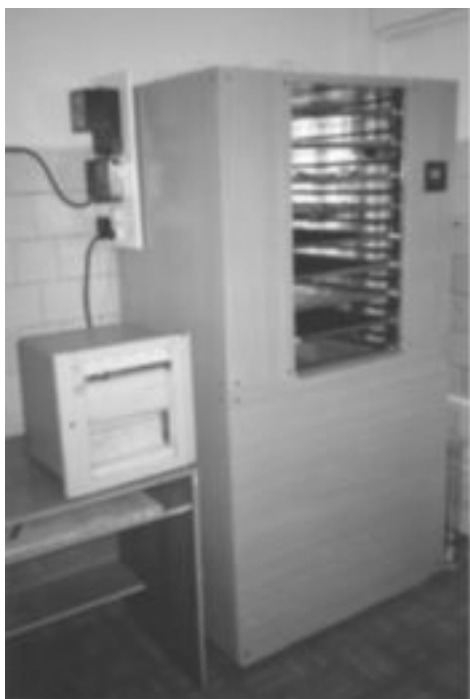
Рис. 4. Теплонасосна сушильна шафа з продуктивністю 4 кг/год по вилученій волозі.
