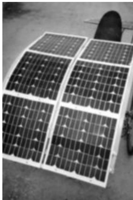
*Рис. 10. Солнечные батареи для электромобиля.*
