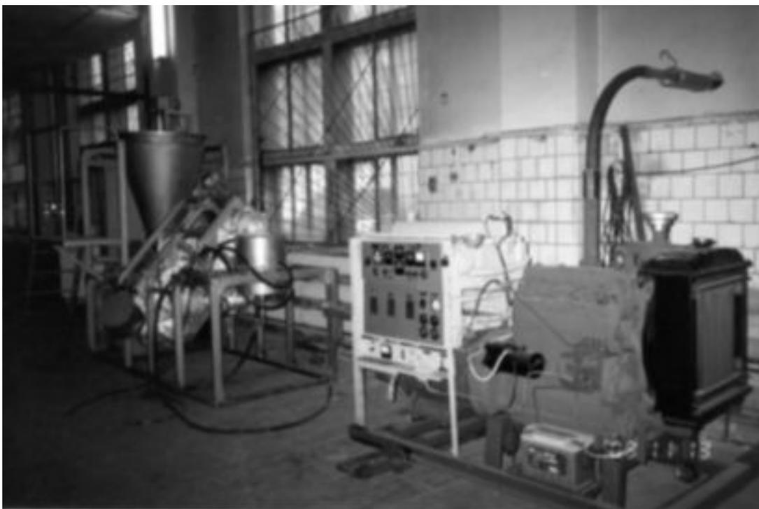
*Рис. 8. Общий вид установки для получения жидкого и газообразного топлива и дизель-генератор (справа) электрической мощностью 20 кВт.*
